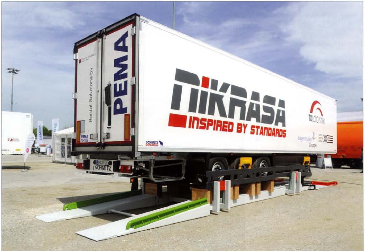
Das System NIKRASA, präsentiert auf der Transportlogistic 2015 in München. Von oben: der Trailer, in Schwarz der eigentliche Zwischenrahmen mit den gelben Greifkanten, hier zur besseren Übersicht auf Holzblöcken abgestützt. In Grau die auf den Boden liegende kranbare Terminalplattform mit den roten Greifkanten für eine allfällige Verlegung innerhalb des Terminals.
