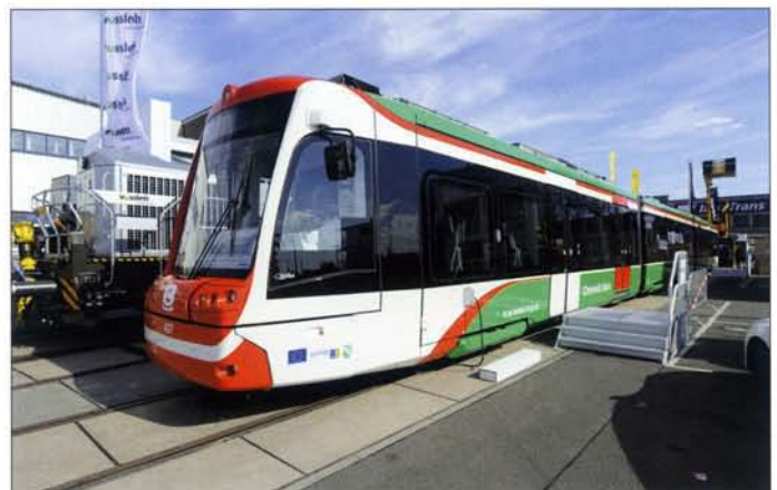
Citylink Chemnitz von Stadler / Vossloh Kiepe. Die unterschiedliche Einstiegshöhe der Türen ist hier gut zu erkennen.
