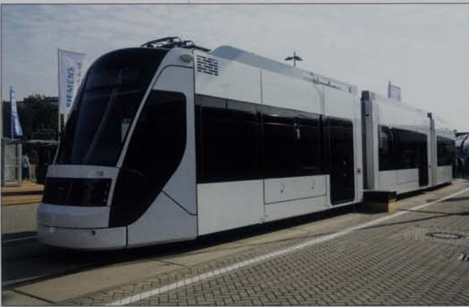
Siemens Avenio für Doha. Auf dem Dach ist der Stromabnehmer zu sehen, der in den Stationen zum Laden der Energiespeicher verwendet wird.
