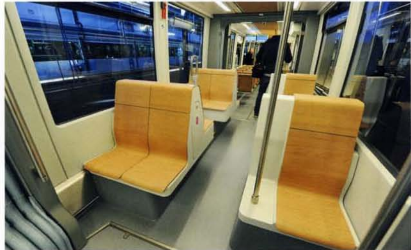
Links: Im ersten Sänftenmodul stehen zwei Rollstuhlplätze zur Verfügung. Rechts oben: Zeitgemäße Touchscreens prägen das Cockpit. Rechts unten: Kiel liefert die ergonomisch geformten Buchenholzsitze, die über den Fahrwerken in Vis-à-vis-Anordnung gruppiert sind.
