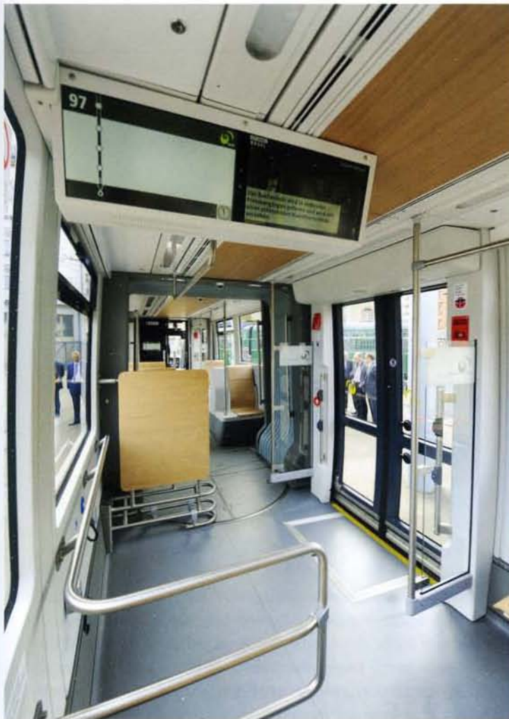
Links: Im ersten Sänftenmodul stehen zwei Rollstuhlplätze zur Verfügung. Rechts oben: Zeitgemäße Touchscreens prägen das Cockpit. Rechts unten: Kiel liefert die ergonomisch geformten Buchenholzsitze, die über den Fahrwerken in Vis-à-vis-Anordnung gruppiert sind.
