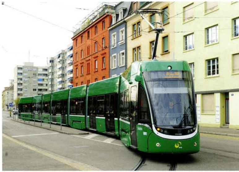
Imposant: Der siebenteilige FLEXITYBasel ist 43,26 Meter lang und bietet sechs Doppel- und zwei Einzeltüren.
