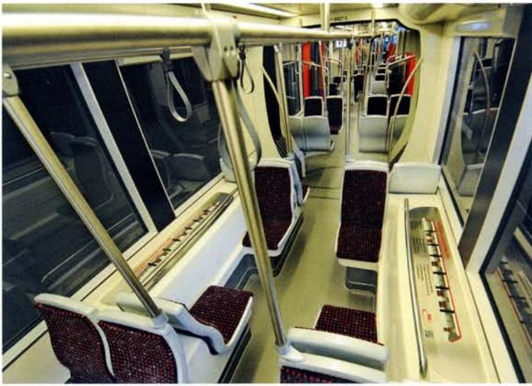
Ungewöhnlich: Die breiten »Fensterbretter« über den angetriebenen Fahrwerken. Hier ist nur eine 1+1-Bestuhlung möglich.
