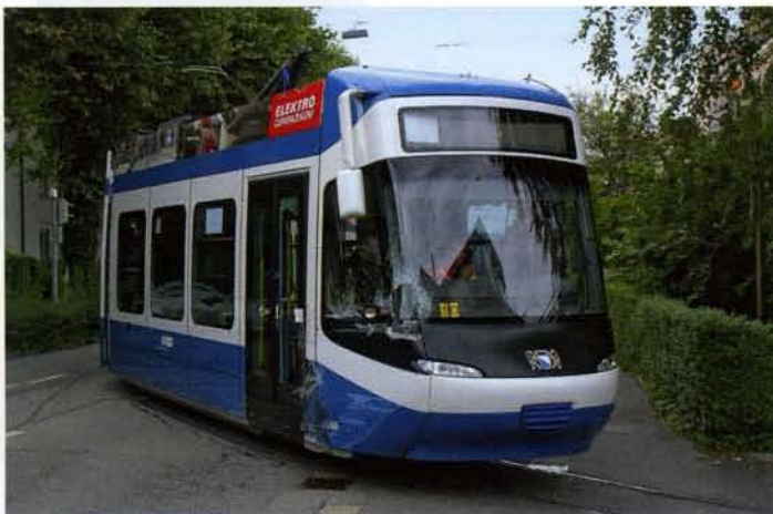
Oben: Nach einer Streifkollision mit einem LKW entgleiste das vorderste Modul des Cobra 3048 bei der Haltestelle Post Wollishofen. Wie die Spuren zeigen, hat sich das Tram in einem stetig enger werdenden Radius von der Gleisachse wegbewegt (Foto: J. Lüthard, 13. August 2010).
