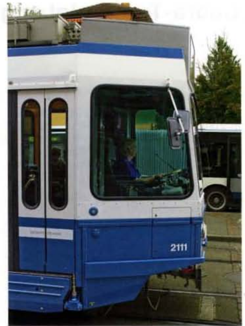
Die Kurzkupplung ragt nicht mehr über die Stirnwand hinaus, was bei Kollisionen ein Nachteil sein dürfte (Foto: J. Lüthard).
