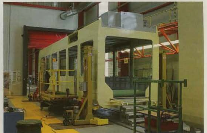
Das Bombardier-Werk Villeneuve baut neue Zwischenwagen für die ABe 4/6 der FART (Foto: Th. Stolz).
