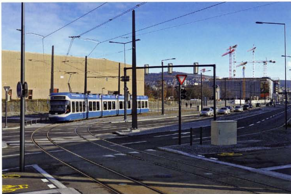
Nähe der Haltestelle Aargauerstrasse wird den Trams „kein Vortritt“ signalisiert, während die Pflingstweidstrasse als Hauptstrasse ausgewiesen wird. Im Normalfall regeln Lichtsignale den Verkehr (Foto: J. Lüthard, 25. Dezember 2011).
