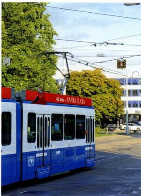
Ein stadteinwärts fahrendes VBZ-Tram der Linie 2 passiert die Abzweigung zur Zentralwerkstätte. Das Weichensignal zeigt nicht mehr die Zungenlage mittels „>“ und „<“ an, sondern in gerader Stellung die Fahrrichtung mit einem „I“. Für die gegenüberliegende Weiche ist das Signal von hinten erkennbar (Foto: J. Lüthard, 28. August 2014).
