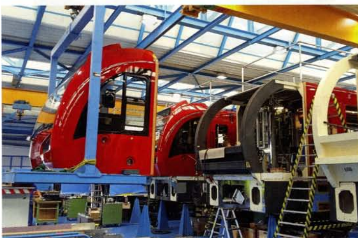
Unten links: Fertigung der TPF-Züge im Stadler-Werk Bussnang. Gut zu erkennen ist die wegen des Rollbockbetriebs angebrachte Brüstungsverstärkung (Foto: U. Wieser).
