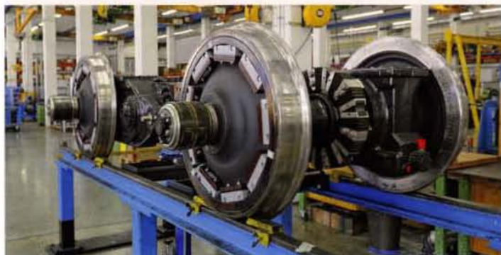
Links: Triebbradsatz mit Schallabsorbern an den Radscheiben. Der gummigefederte Stern zur Traktionskraftübertragung stützt – wie bei einem Tatzlagerantrieb – auch den Motor mit dem Getriebe auf der Achse ab. An der hinteren Achse ist einer der gummigefederten Aufhängepunkte des Fahrmotors am Drehgestellrahmen erkennbar (Foto: J. Lüthard).
