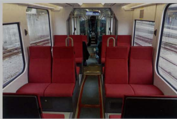
Fahrgastraum mit Sitzplätzen zweiter Klasse, von denen insgesamt 135 (davon 24 Klappsitze) zur Verfügung stehen. Der Mittelgang ist wegen des auf 2,4 Meter beschränkten Profils ziemlich schmal (Foto: M. Rellstab).
