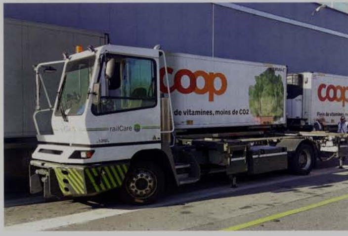
Links: Horizontalumschlag eines Wechselbehälters mittels Terminalfahrzeug im Railcare-Hub Aclens (Foto: M. Rellstab, 25. Oktober 2018).
