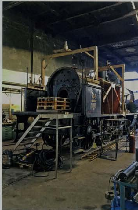
Die vom Verein Dampfgruppe Zürich übernommene, teilzerlegte Dampflokomotive A 3/5 705 während der Revision (Foto: pd).
