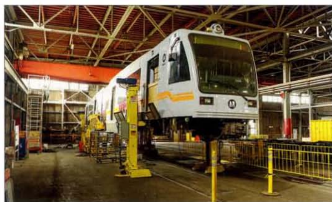
Alstom: Die P2000 LRV aus Los Angeles erhalten am Alstom-Standort nördlich von San Francisco ein Retrofit
