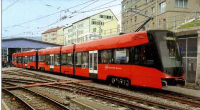
St. Gallen: Anlässlich der Pressevorstellung am 26. März präsentiert sich der erste Tango vor dem Depot Speicher. Es fehlen noch die Drehgestell- und Frontblenden sowie teilweise die Außenanschriften JÜRGEN D. LÜTHARD
