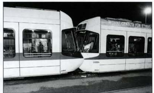
Der Kopf der Cobra 3064 ist am 11. Oktober 2013 richtiggehend in den Schwanz der Cobra 3068 verkeilt, beide wurden beim Unfall schwer beschädigt. Photo: Jürg Lüthard
