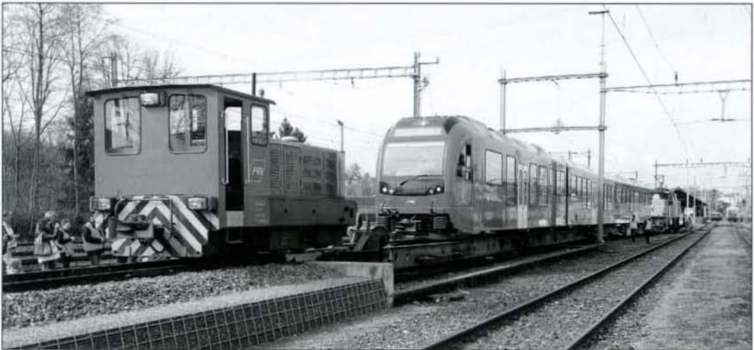
Am 27. März 2018 empfangen die AB in Gossau ihren ersten Triebzug namens Walzer auf ihren Schienen. Insgesamt sind fünf dieser dreiteiligen Züge bestellt. Sie werden ausschliesslich auf der S23 Gossau – Herisau – Appenzell – Wasserauen zum Einsatz kommen. Der Triebzug 1001 wurde auf Rollschemeln von der Stadler Fabrik in Bussnang nach Gossau transportiert, wo ihn der Tm 2/2 58 Schorsch in Kürze auf das Schmalspurgleis der AB ziehen wird. Photo: Jürg D. Lüthard
