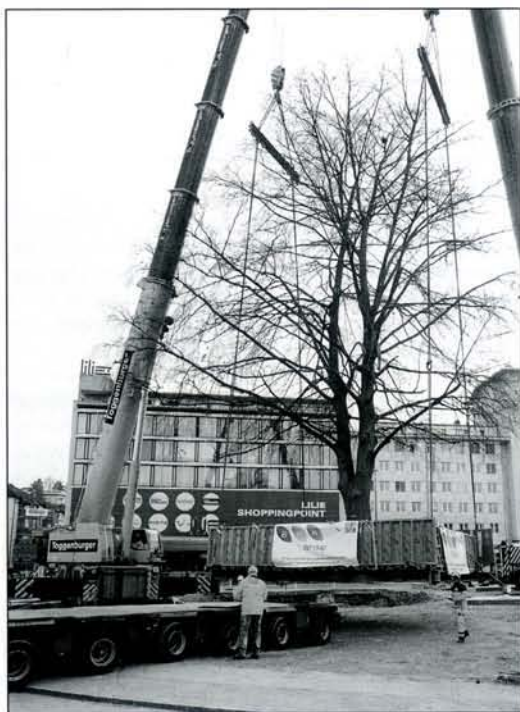
Der Baum wird von zwei Kränen auf einen Tieflader gehievt. Photo: Jürg D. Lüthard
